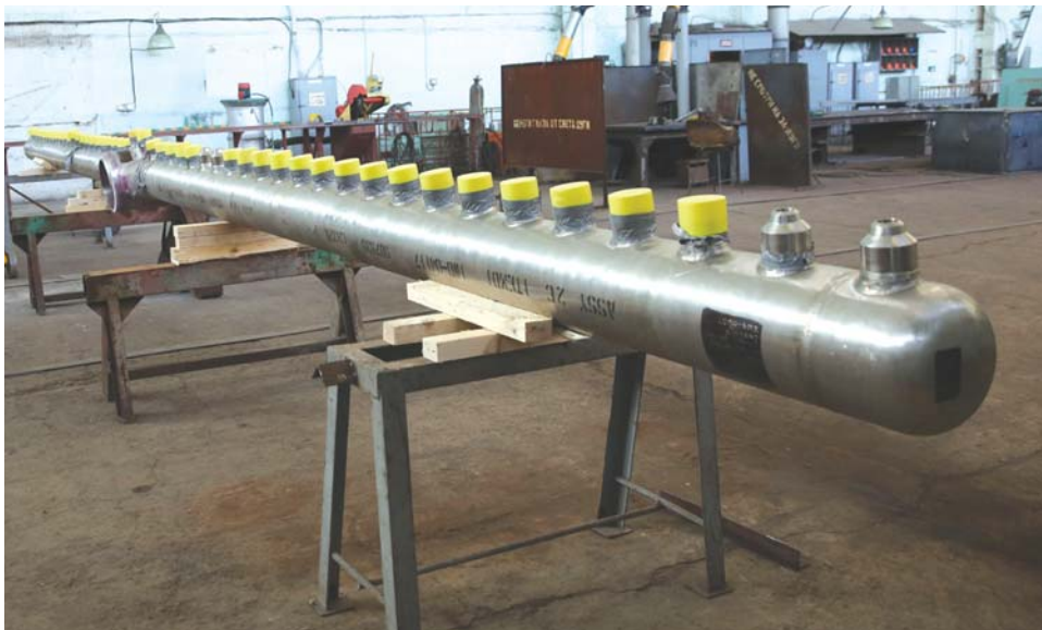
Выпускной коллектор печи В-201 установки производства водорода
