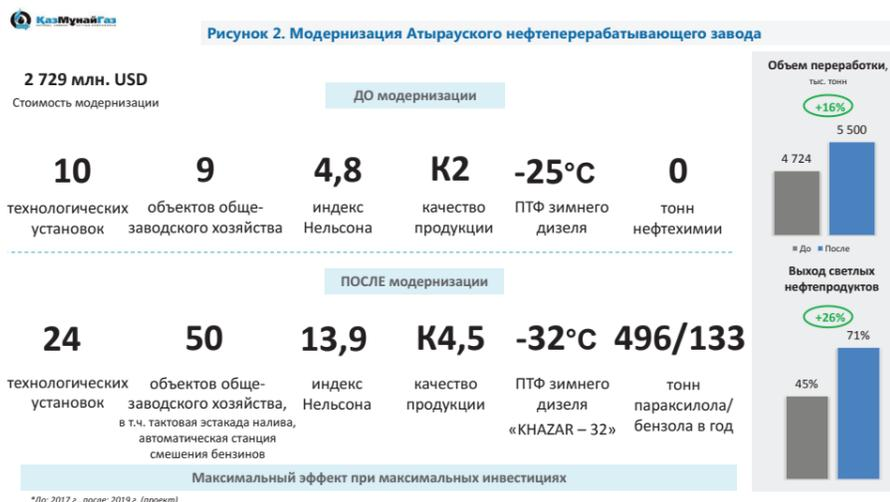
АНПЗ сегодня - единственный завод в РК, который производит базовую нефтехимию - бензол в объеме 133 тыс. т в год и параксилон в объеме 496 тыс. т в год. В ноябре на АНПЗ начали выпуск зимнего дизеля с предельной температурой фильтруемости -32°C с фирменным названием «Kazazar-32». На рисунке 2 приведены сведения об АНПЗ до и после модернизации.
