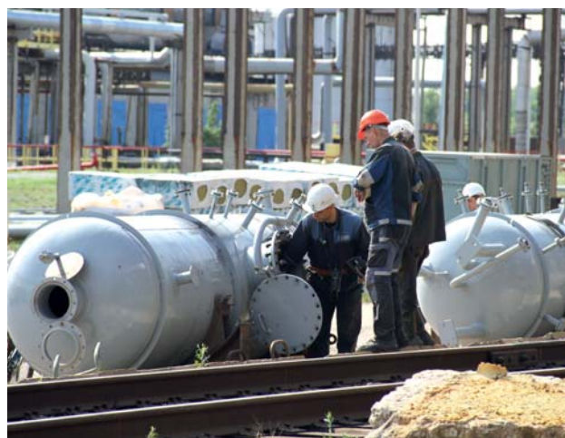
ОПК проводят входной контроль сепараторам Е-607 и Е-608 С-100
